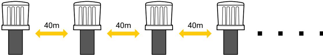
電源を入れると自動で通信を開始し、同期が完了すると周囲の製品と同時に点滅します。
